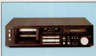
⑪ RS-M 273 Mikroprozessorgesteuertes HiFi-Cassettendeck mit 2 Motoren und 3 Tonköpfen.
