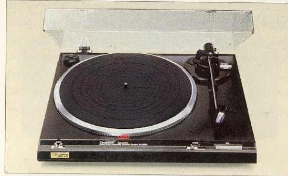
SL-Q 200 Halbautomatischer Plattenspieler mit quargeregeltem Direktantrieb. Komplette Frontbedienung. TNRC-Zarge. Magnettonabnehmer EPC-P 30. Gleichlaufschwankungen \pm 0,035 %. Rumpel-Geräuschspannungsabstand: - 78 dB. Gehäusefarben: schwarz und silber.
