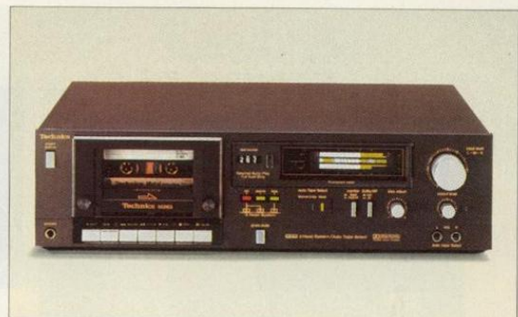
RS-M 263 3-Kopf-HiFi-Cassettendeck mit Hinterbandkontrolle, Dolby-B. Automatische Bandsortenwahl (Normal/CrO 2 /Reineisen), Regeltbare Vormagnetisierung, FL-Meter mit „peak-hold“. Übertragungsbereich 25 Hz – 19 kHz (Reineisen). Gehäusefarben: schwarz und silber.
