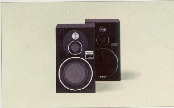
SB-X 100 3-Weg-Lautsprecherbox mit Wabenscheiben-Flachmembran. Baßreflex-System. Impedanz 8 Ohm. Belastbarkeit: 50 W Sinus/100 W Musik. Gehäusefarbe: schwarz.
