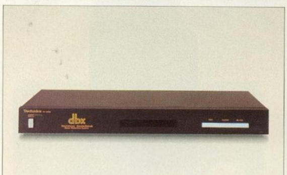
RP-9024 dbx-Kodierer/Dekodierer, entwickelt für die Verwendung mit jedem beliebigen Cassettendeck. Dynamikbereich 110 dB, „dbx-disc“-Position. Gehäusefarbe: schwarz.
