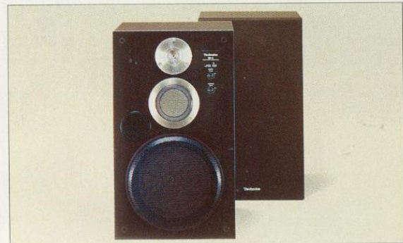
SB-6 3-Weg-Baßreflexbox. Tief-, Mittel- und Hochtöner mit Wabenscheiben-Flachmembran. Impedanz: 8 Ohm. Belastbarkeit: Sinus 75 W, Musik 120 W. Übertragungsbereich 38 Hz – 35 kHz. Schalldruck: 93 dB/W (1 m). Gehäusefarbe: rosenholz.
