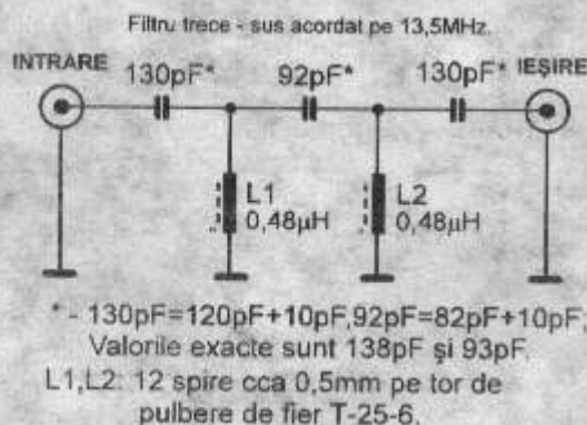
Figura 3. Filtrul trece-sus acordat pe 13,5MHz.
