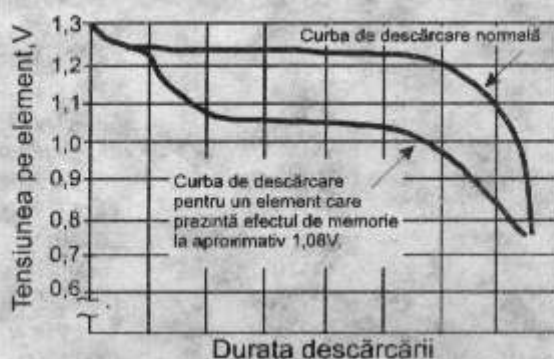
Figura 1. Caracteristica de descărcare a unui acumulator NiCd normal și a unui care prezintă efectul de memorie.
