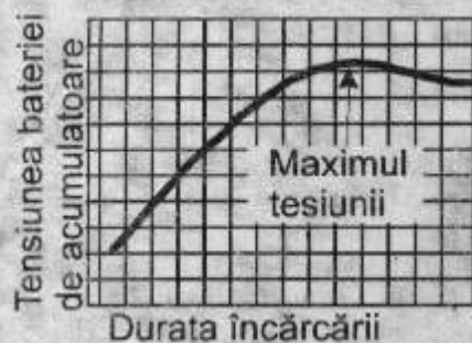
Figura 4. Prin detectarea valorii maxime a tensiunii pe bateria de acumulatori, unele încărcătoare iau decizia de a opri încărcarea sau de a comuta pe un curent de menținere a încărcării.
