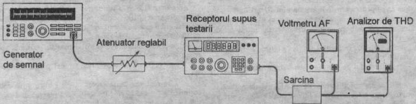
Fig. 4 Montajul de test pentru măsurări de sensibilitate SINAD. De remarcă că voltmetrului de la ieșire i s-a adăugat și un analizor de distorsiuni.
