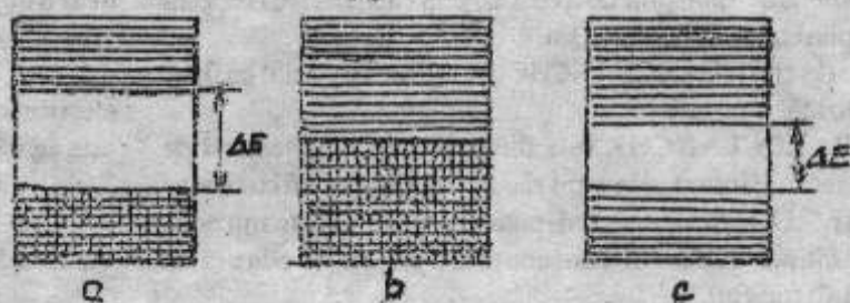
Fig. 1.2. Diagrama benzilor de energie: a. izolatoare; b. metale; c. semiconductoare
