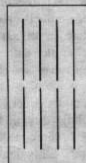
Fig. 13 Un grup de dipoli asigură o creștere a sensibilității într-o direcție prestabilită, uzual pe direcție perpendiculară pe planul suprafeței reflectante. Utilizată împreună cu un dispozitiv de aviere electronică a fazei pentru fiecare element, această rețea poate avea directivitatea controlată electric.
