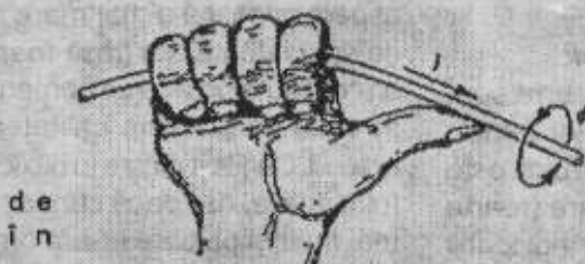
Fig. C Regula "mîinii drepte" arată legătura între direcția curgerii curentului și cîmpul magnetic pe care acesta îl produce.
