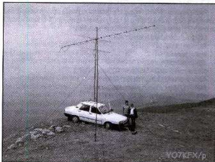
Echipa de la YO7KFX/p, Marcel YO7BSN și Florin YO7LXB, operând de pe Vârful Păpușa, 2150 m ASL. Echipament ICOM IC 910H și 16 elem (VHF), 19 elem. (UHF) și 35 elem. SHF.
