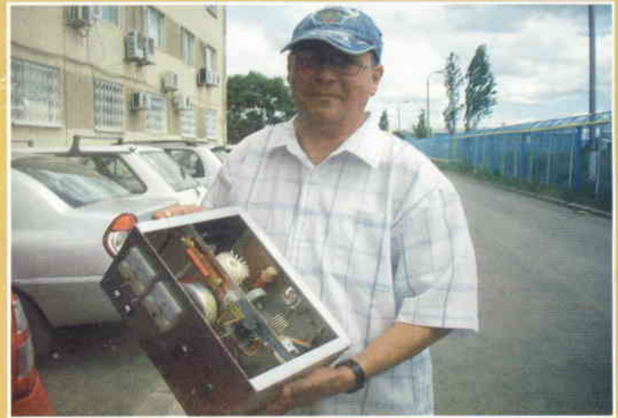
YO4RDN și liniarul construit pentru 6m
