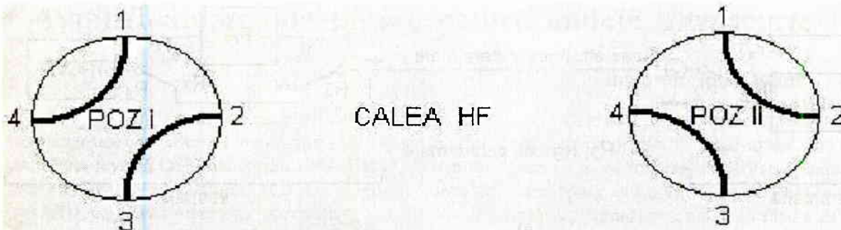
Fig.7 Diagrama de acționare a contactelor de confirmare a poziției releului
