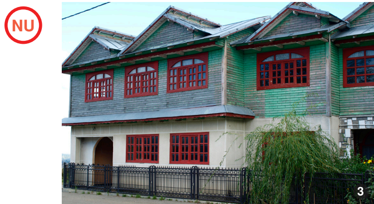
AȘA NU: Forma acoperișului intră în totală contradicție cu noțiunea de încadrare în specific local. Pe lângă asta clădirea prezintă și alte neconcordanțe: volum masiv, distanță prea mică până la limita de proprietate în comparație cu volumul, finisaje, goluri, tipuri de ferestre necorespunzătoare.
