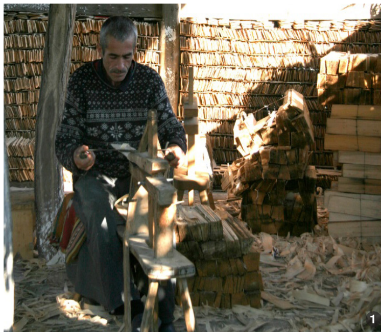
Unelte tradiționale pentru realizarea șindrilăi.
