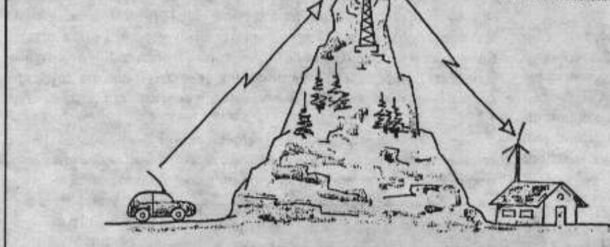
Fig. 1.4 Stațiile repeter măresc aria de acoperire.
