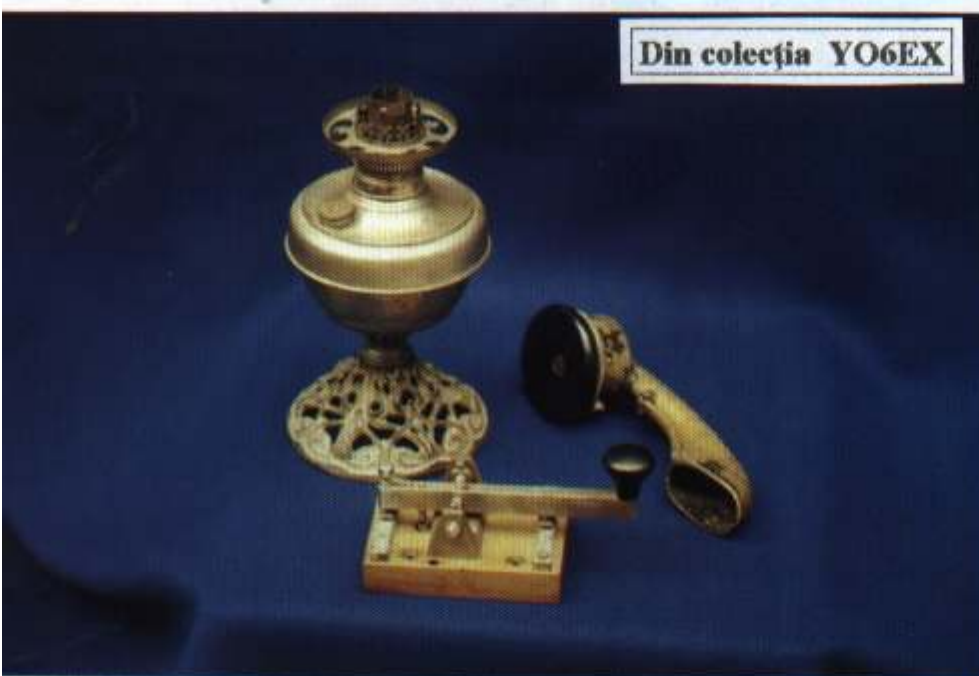
Exponate din colecția personală a lui YO6EX Vasile Giurgiu din Sibiu Lampă cu petrol, manufactură, Viena 1870 Manipulator telegrafic utilizat în comunicațiile din transportul feroviar în jurul anului 1910, transmisii pe cablu cu recepție pe panglică de hârtie. Micro-receptor telefonic cu pâlnie. Are o clapetă pe care scrie "Apasă când vorbești!"
